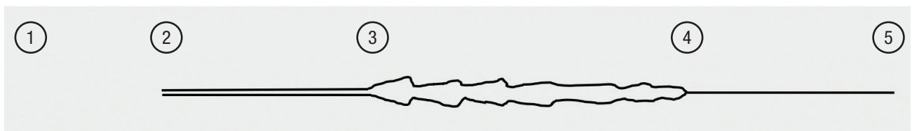
Abb. 3 // Trocknungsphasen einer Beschichtung, wie sie während der Prüfung mit einem Trocknungszeitmessgerät zu erkennen sind.
